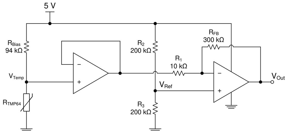
図 9-6. TMP64-Q1 分圧器とレール・ツー・レール・オペアンプを使用したサーマル・フォールドバック
