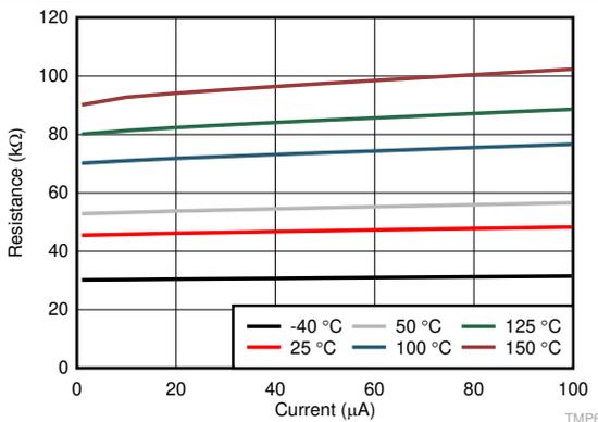
図 7-5. 電源依存抵抗対バイアス電流
