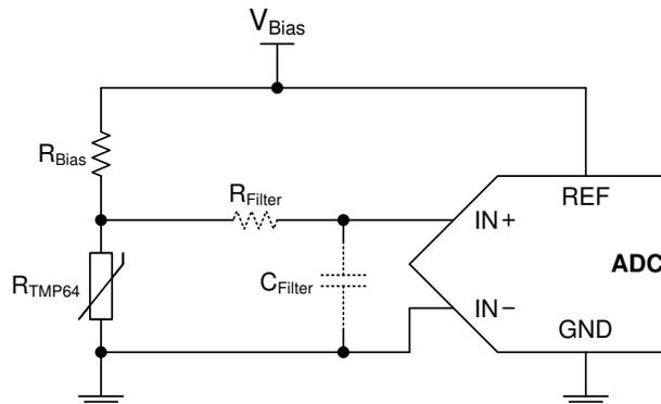
図 9-2. ADC を使用した TMP64-Q1 分圧器
