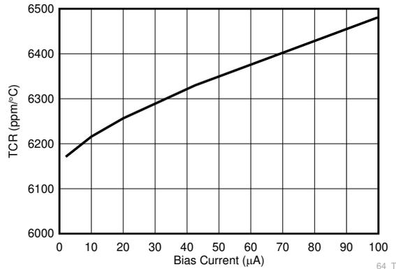
図 7-3. センス電流  $I_{\text{SNS}}$  の機能としての TCR
