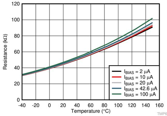
図 7-1. 抵抗対周囲温度 (各種バイアス電流)
