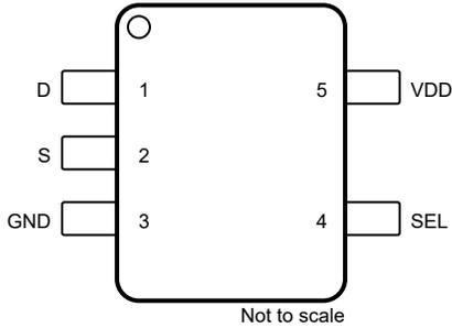
図 5-1. DCK Package 5-Pin SC70 (Top View)
