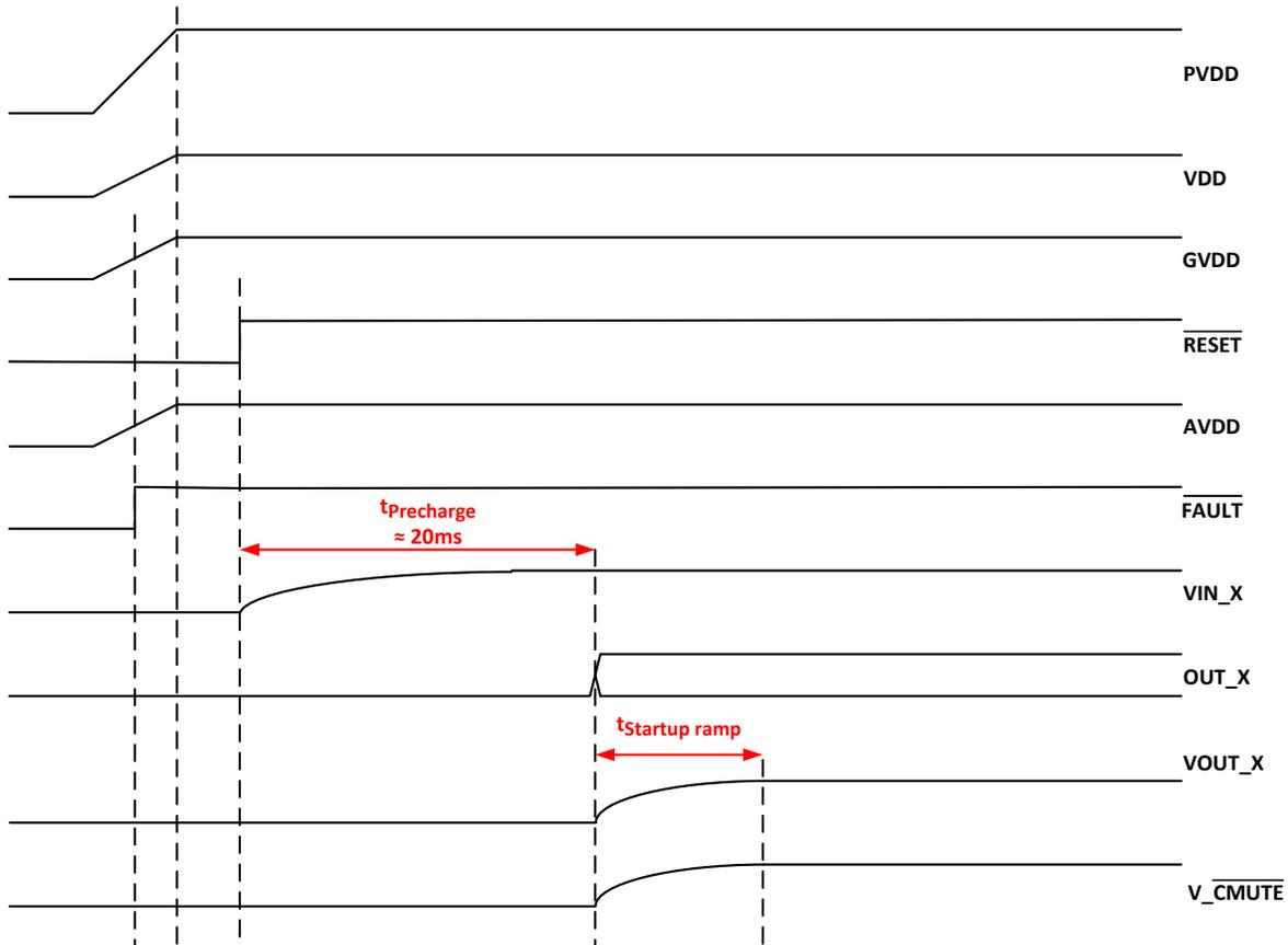
図 9-13. Startup Timing
