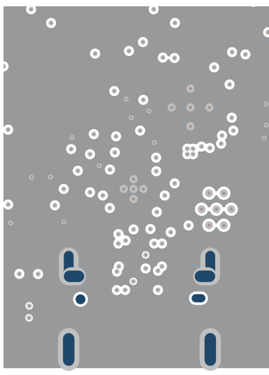
図 7-6. TPS26750 PCB Layout - GND Layer 2
