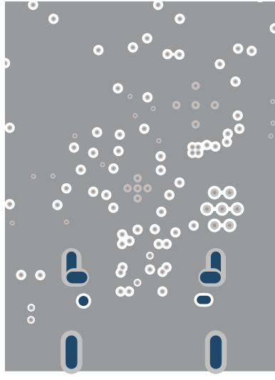
図 7-9. TPS26750 PCB Layout - GND Layer 5
