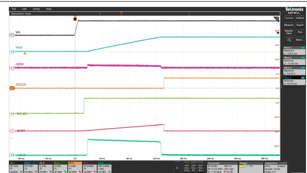
図 6-20. EN が抵抗経路で VIN に接続されている状態で入力電源を使用した起動シーケンシング
