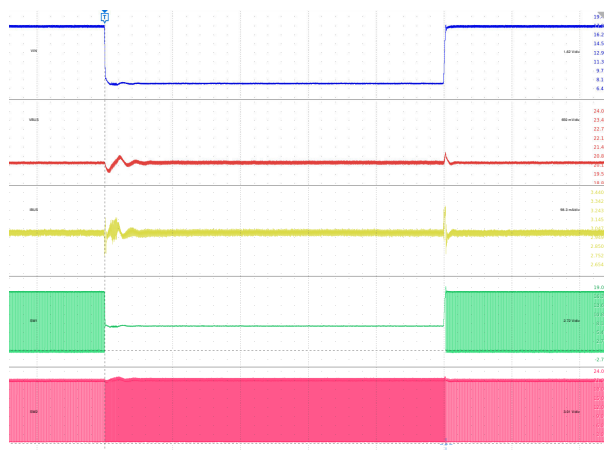
図 9-33. Load Transient (Boost): V_{BUS} = 20V
