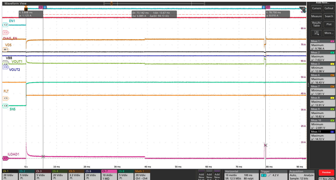
図 8-23. 初回の再試行ウィンドウでサーマルレギュレーション動作を行いながら拡張された再試行ウィンドウへ移行するデバイスの動作
