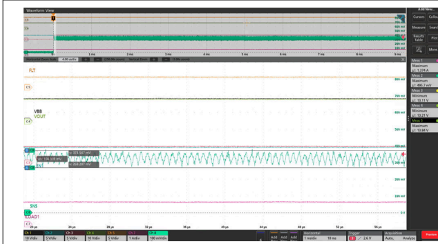
図 8-10. V_{BB} = 13.5V , I_{LIM} = OPEN , R_L = 10\Omega , R_{SNS} = 1k\Omega , T_A = 25^\circ C における C_{SNS} なし時の SNS ピンリップル
