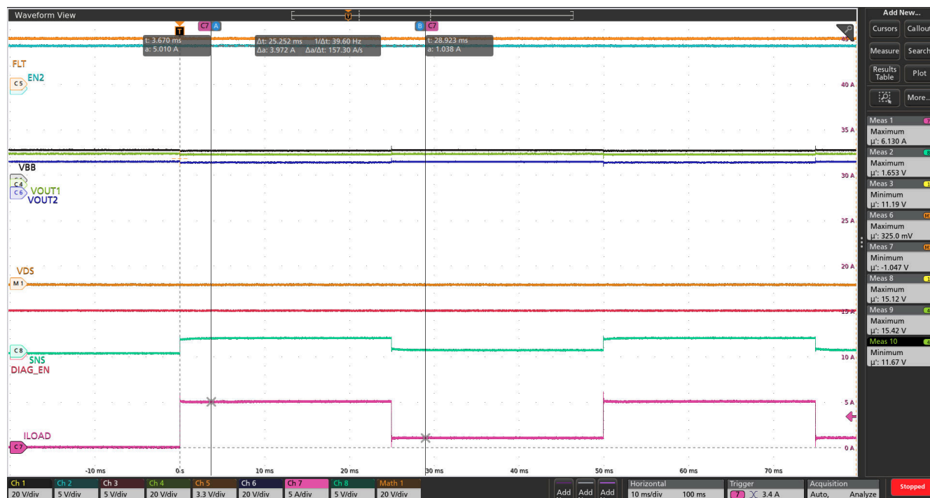
図 8-4. チャンネル 1 の負荷電流変化時の SNS ピン電圧 ( R_{SNS} = 1k\Omega , SEL = 0 )
