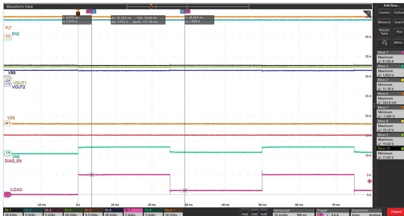
図 8-4. チャンネル 1 の負荷電流変化時の SNS ピン電圧 ( R_{SNS} = 1k\Omega , SEL = 0 )
