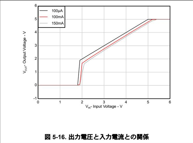
図 5-16. 出力電圧と入力電流との関係
