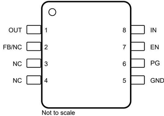
図 4-1. D パッケージ、8 ピン SOIC (上面図)
