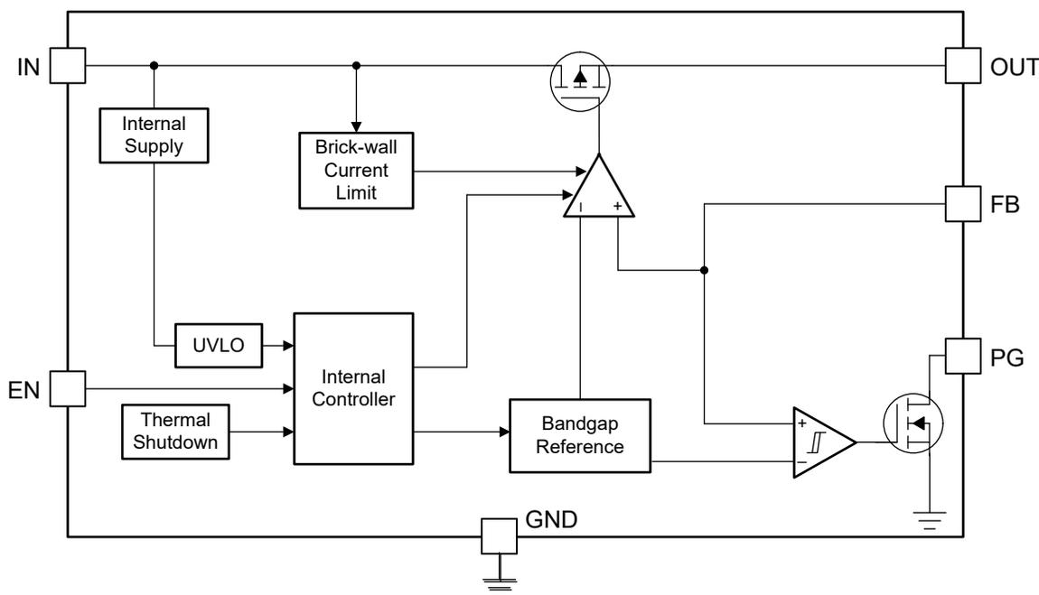
図 6-1. 可変出力のブロック図
