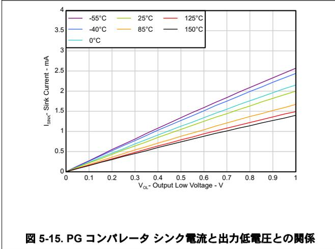
図 5-15. PG コンパレータ シンク電流と出力低電圧との関係
