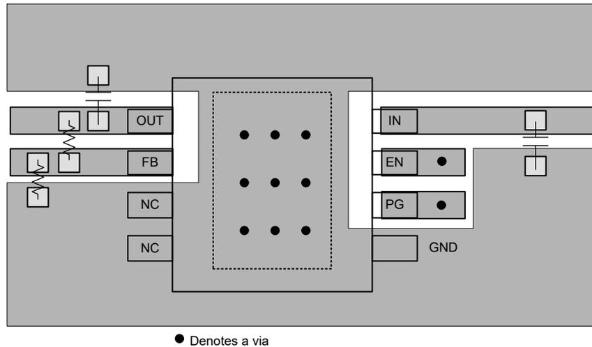
図 7-7. SOIC (D) パッケージ (可変出力)
