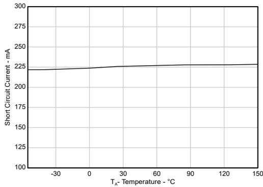
$V_{IN} = 6 V$ 、 $V_{OUT} = 0 V$
