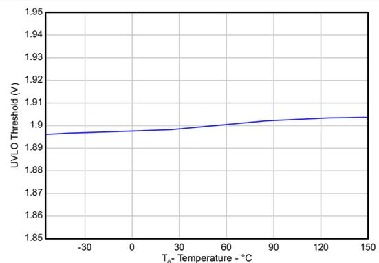
図 5-12. 低電圧誤動作防止 (UVLO) スレッシュホールドと温度との関係
