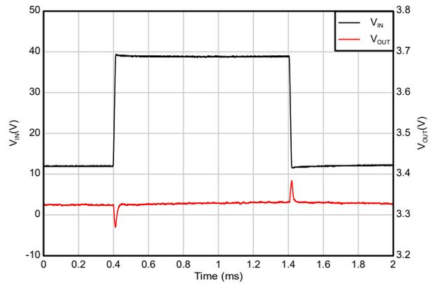
$V_{IN} = 12\text{V} \sim 40\text{V}$ 、 $V_{OUT} = 3.3\text{V}$ 、 $I_{OUT} = 150\text{mA}$ 、スルーレート =  $2\text{V}/\mu\text{s}$
