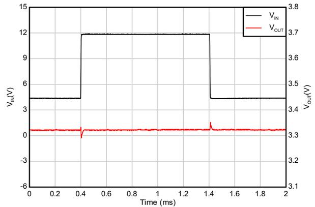
$V_{IN} = 4.3\text{V} \sim 12\text{V}$ 、 $V_{OUT} = 3.3\text{V}$ 、 $I_{OUT} = 150\text{mA}$ 、スルーレート =  $2\text{V}/\mu\text{s}$
