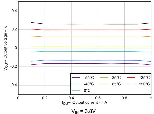
図 5-4. 精度と出力電流との関係
