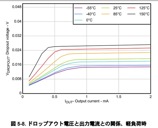
図 5-8. ドロップアウト電圧と出力電流との関係、軽負荷時
