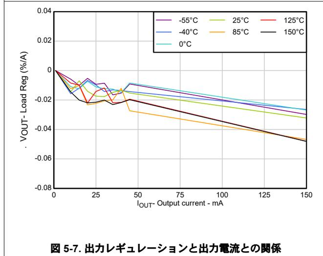
図 5-7. 出力レギュレーションと出力電流との関係
