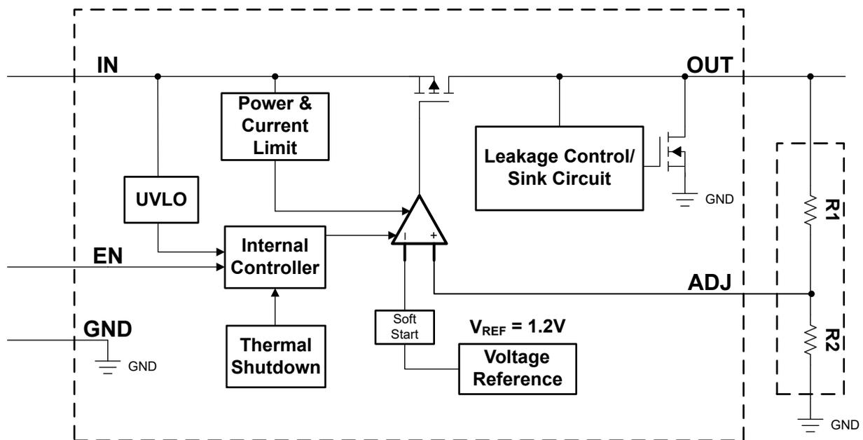
図 6-1. 機能ブロック図：可変バージョン
