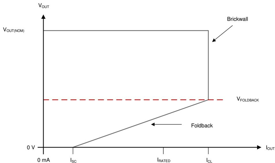
図 6-3. フォールドバック電流制限
