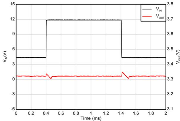
$V_{IN} = 4.3\text{V} \sim 12\text{V}$ 、 $V_{OUT} = 3.3\text{V}$ 、スルーレート =  $2\text{V}/\mu\text{s}$
