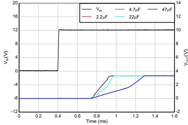
$V_{EN} = V_{IN}$ 、 $V_{OUT} = 3.3\text{V}$ 、スルーレート =  $1\text{V}/\mu\text{s}$
