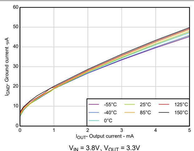
図 5-12. グランド電流と出力電流との関係
