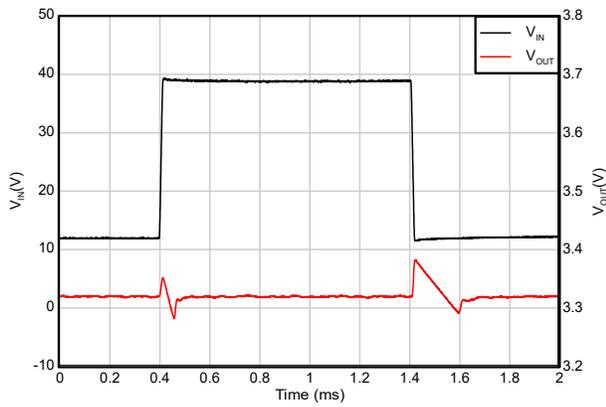
$V_{IN} = 12\text{V} \sim 40\text{V}$ 、 $V_{OUT} = 3.3\text{V}$ 、スルーレート =  $2\text{V}/\mu\text{s}$
