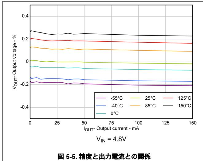
図 5-5. 精度と出力電流との関係
