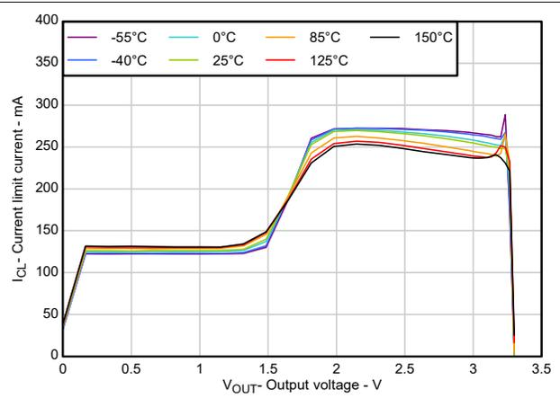
図 5-10. 電流制限と出力電圧との関係
