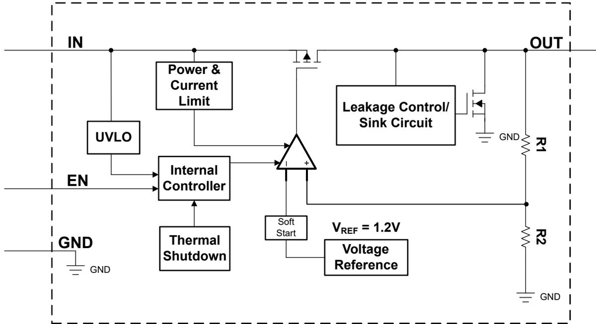
図 6-2. 機能ブロック図：固定バージョン
