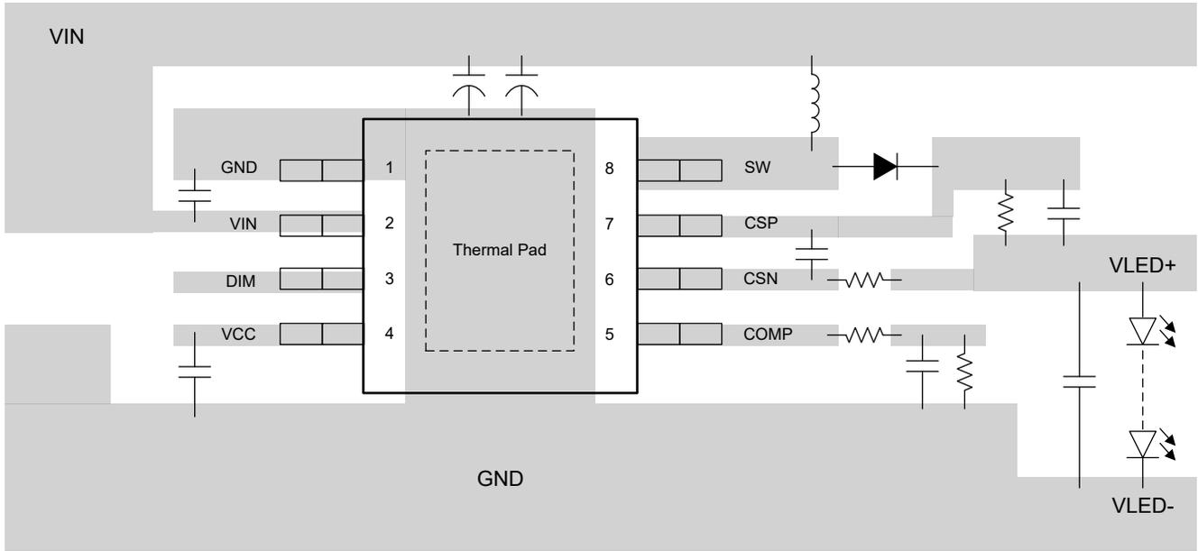
図 8-22. 8-Pin HVSSOP Top View Layout Example
