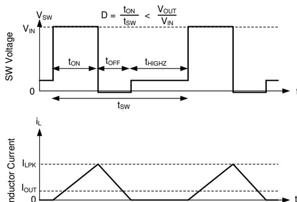
自動モードでは、インダクタ電流がゼロに近づくとローサイド デバイスはオフになります。その結果、出力電流が CCM でインダクタリップルの 1/2 未満になると、本デバイスは DCM で動作します。この動作は、ダイオード エミュレーションが機能しているということと等価です。
