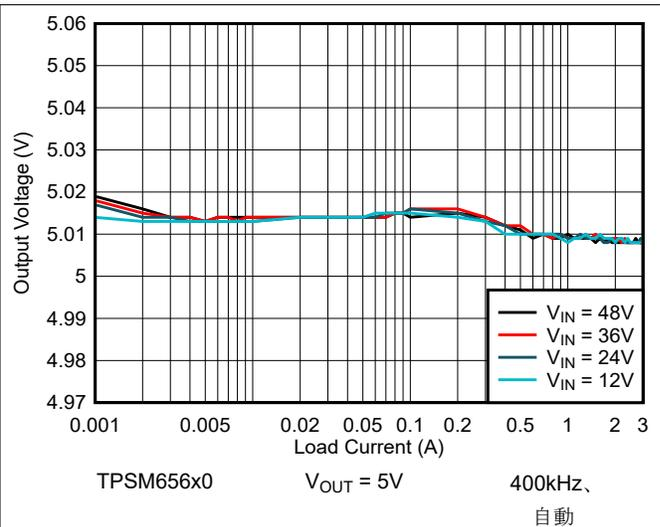
図 8-6. ラインおよびロードレギュレーション
