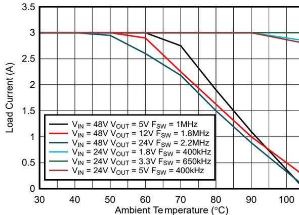
図 8-4. 負荷電流ディレーティング
