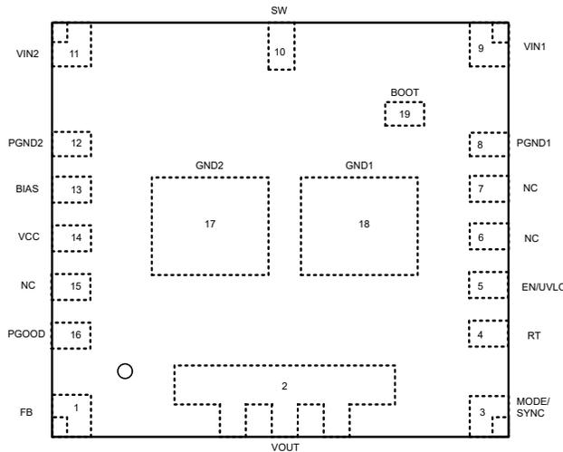
図 5-1. 19 ピン VCG、QFN-FCMOD パッケージ (上面図)
