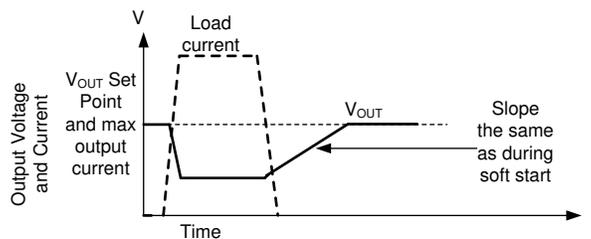
出力電圧の低下が、高負荷と低入力電圧のどちらによるものであっても、出力がその設定点を下回る原因となっている条件が解消された後、起動時と同じ速度で出力は上昇します。ドロップアウトが原因でヒックアップがトリガされなかったとしても、回復中、128 クロック サイクル以上にわたって出力電圧が設定点の 0.4 倍を下回った場合、原則として、回復中にヒックアップがトリガされます。
