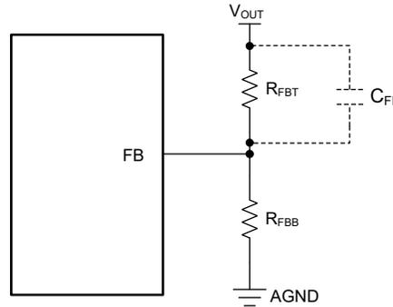
図 7-1. 可変バージョンの出力電圧の設定
