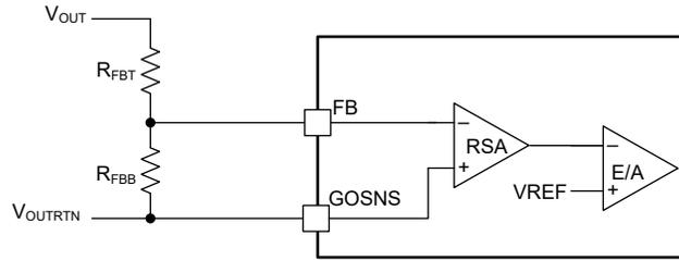
**図 7-5. FB Resistor Divider**
