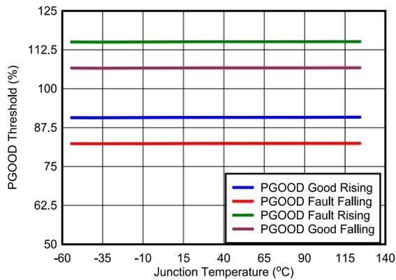
Figure 6-9. PG Threshold
