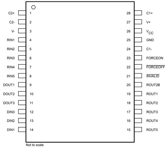
**图 5-1. DB, DW, or PW Package, 28 Pin (SSOP, SOIC, TSSOP)
