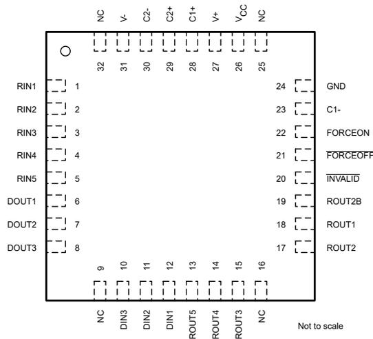
**图 5-2. RHB Package, 32 Pin (VQFN)
