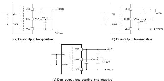
図 8-6. Dual output configurations
