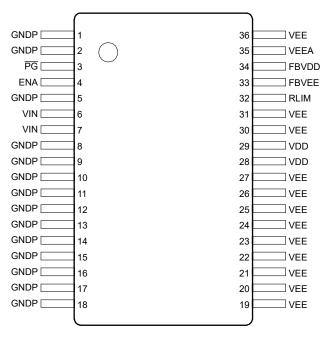
図 5-1. DWN Package, 36-Pin SSOP (Top View)
