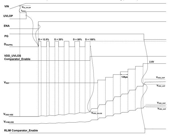
図 7-5. Output Voltage Soft-Start Diagram
