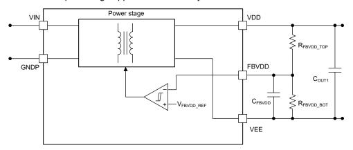
図 7-1. VDD-VEE Voltage Regulation
