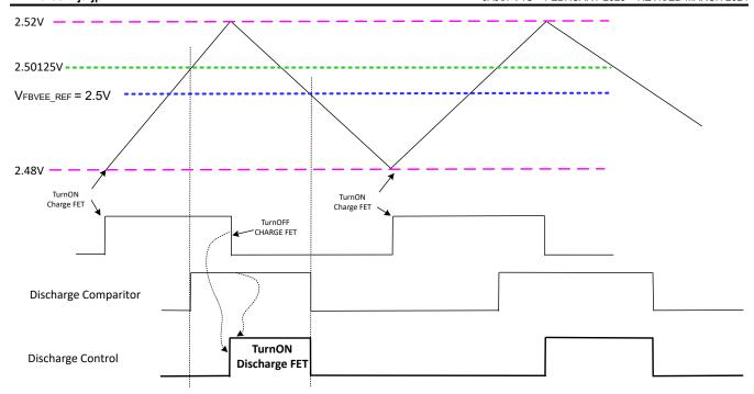
図 7-3. COM-VEE Voltage Regulation Diagram
