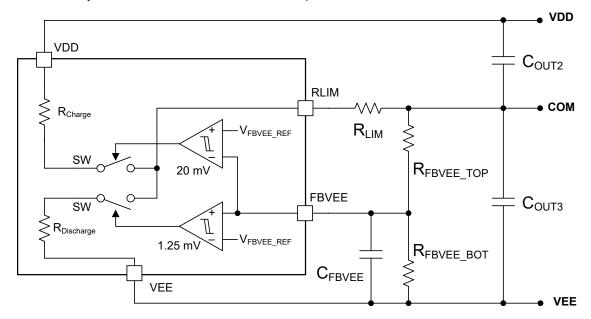
図 7-2. COM-VEE Voltage Regulation
