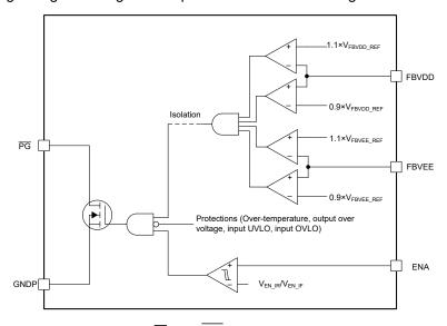
図 7-7. PG Pin Logic
