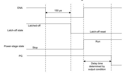
図 7-6. Latch-Off Reset Using ENA Pin
