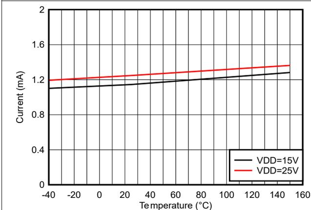
図 5-7. チャンネルあたりの静止消費電流 ( $I_{VDDA/B}$ ) と温度との関係 (無負荷、入力 Low、スイッチングなし)
