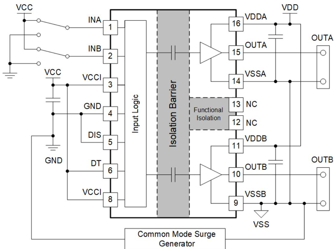
図 6-7. CMTI テスト構成の概略図
