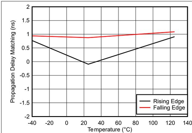
図 5-15. 伝搬遅延マッチング (t<sub>DM</sub>) と温度との関係
