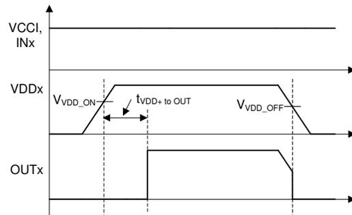
図 6-6. VDDA/B 電源オン時の UVLO 遅延
