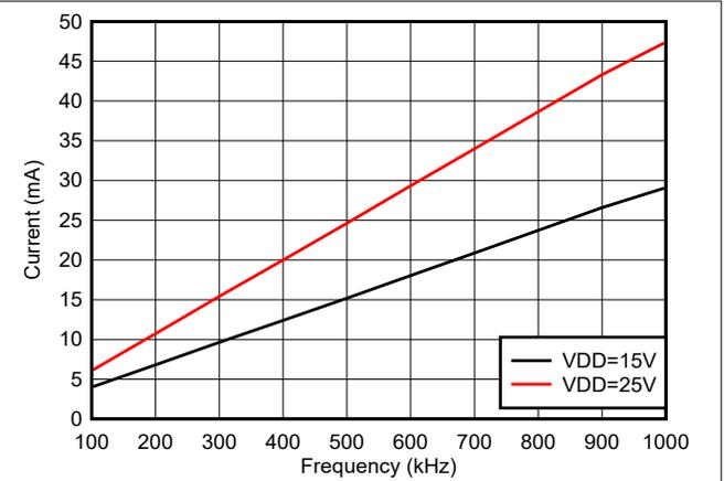
図 5-4. チャンネルあたりの消費電流 ( $I_{VDDA/B}$ ) と周波数との関係 (1nF 負荷、VDD = 15V または 25V)
