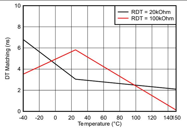
図 5-22. デッドタイム マッチングと温度との関係 ( $R_{DT} = 20\text{k}\Omega$  および  $100\text{k}\Omega$  の場合)
