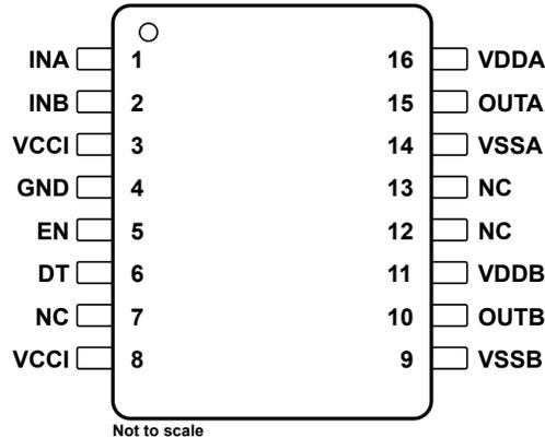
図 4-1. D パッケージ 16 ピン SOIC 上面図
