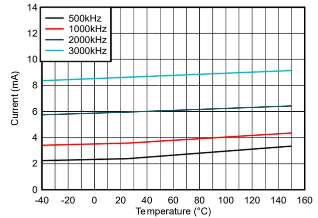
図 5-6. チャンネルあたりの消費電流 ( $I_{VDDA/B}$ ) と温度との関係 (無負荷、各種スイッチング周波数)
