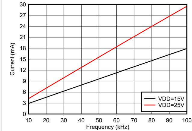
図 5-5. チャンネルあたりの消費電流 ( $I_{VDDA/B}$ ) と周波数との関係 (10nF 負荷、VDD = 15V または 25V)
