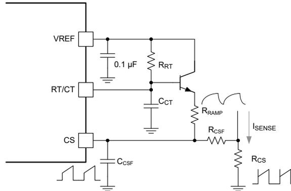
図 7-8. スロープ補償回路
