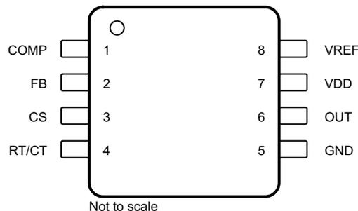
図 5-2. DGK パッケージ、8 ピン VSSOP (上面図)
