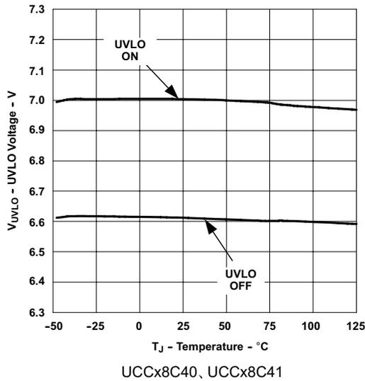
図 6-11. 低電圧誤動作防止と温度との関係
