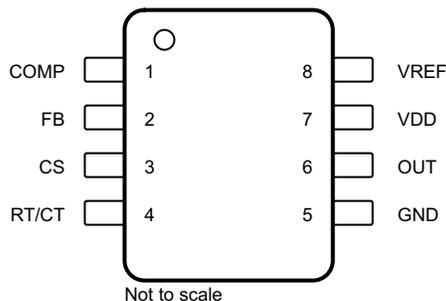
図 5-1. D パッケージ、8 ピン SOIC (上面図)
