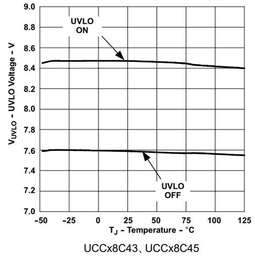
図 6-10. 低電圧誤動作防止と温度との関係
