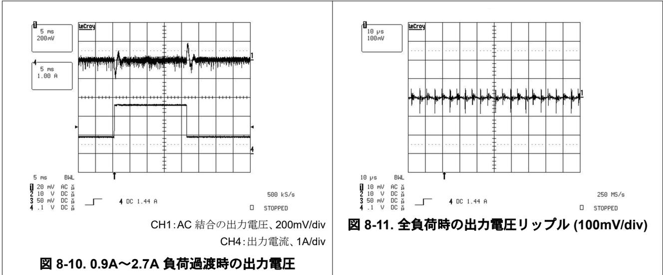
図 8-11. 全負荷時の出力電圧リップル (100mV/div)
