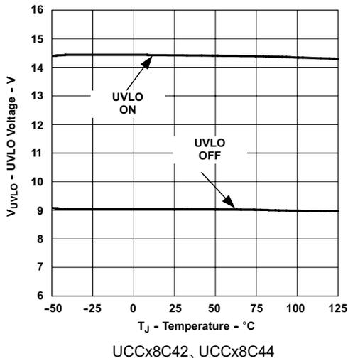
図 6-9. 低電圧誤動作防止と温度との関係
