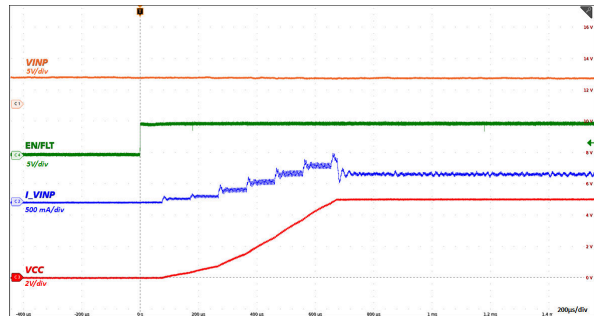
図 6-13. EN/FLT を Low から High に設定したスタートアップ : VINP = 5.0V、VCC = 5.0V、18 Ω 負荷
