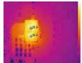
良好な熱性能で40%小型化( $\theta_{JA}=13^{\circ}\text{C/W}$ )
