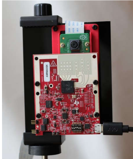
図 3. IMX219 と IWR6843ISK を使用したカメラレーダー センサ モジュール
