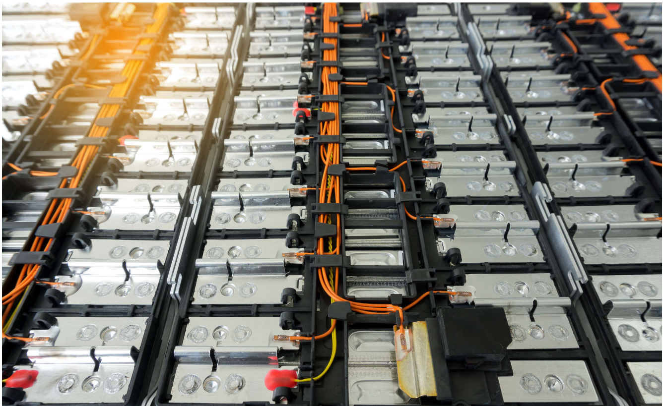
図 3-1. EV バッテリーパック内のリチウムセル
