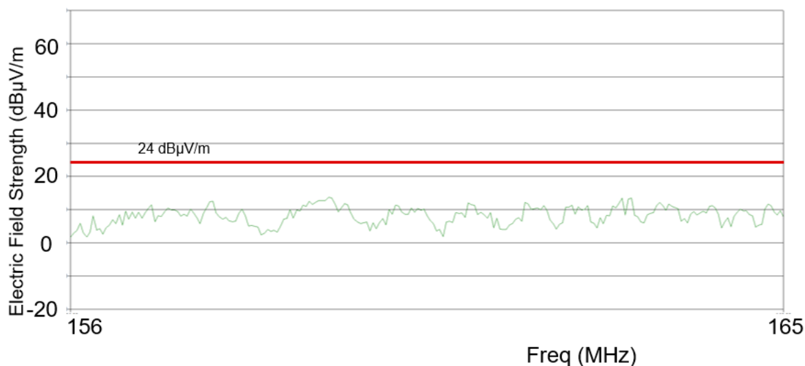
図 3-7. 156MHz ~ 165MHz 5V5 モード (110mA 負荷) における準ピーク放射エミッション データ
