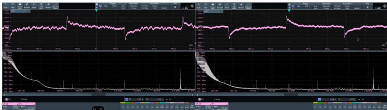
図 3-7. フィードフォワード コンデンサ有無による降圧コンバータ出力電圧の比較
