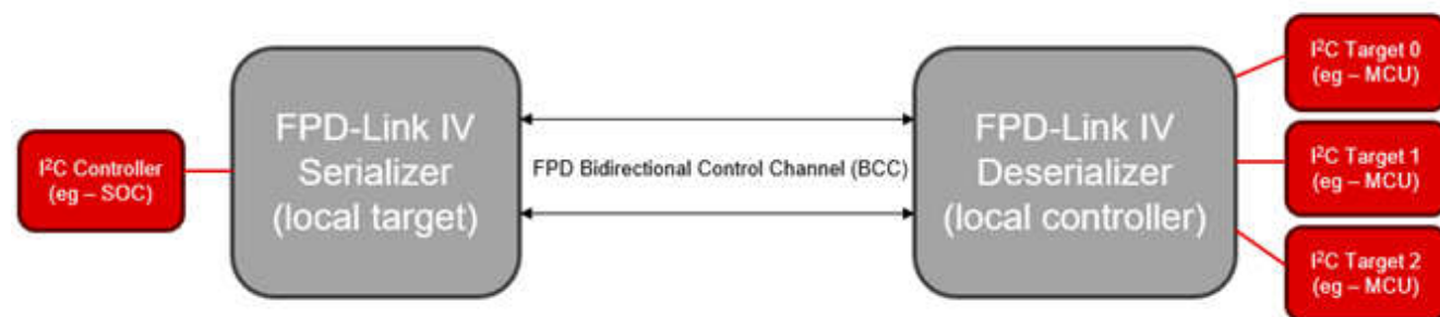
図 3-1. クロック ストレッチに発生する I2C スタック問題の例
