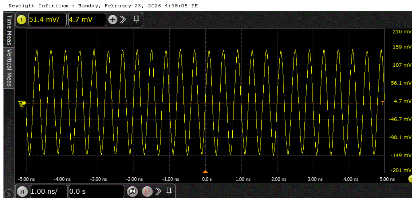
図 4-2. CP1 コンプライアンス パターン - オシロスコープの波形
