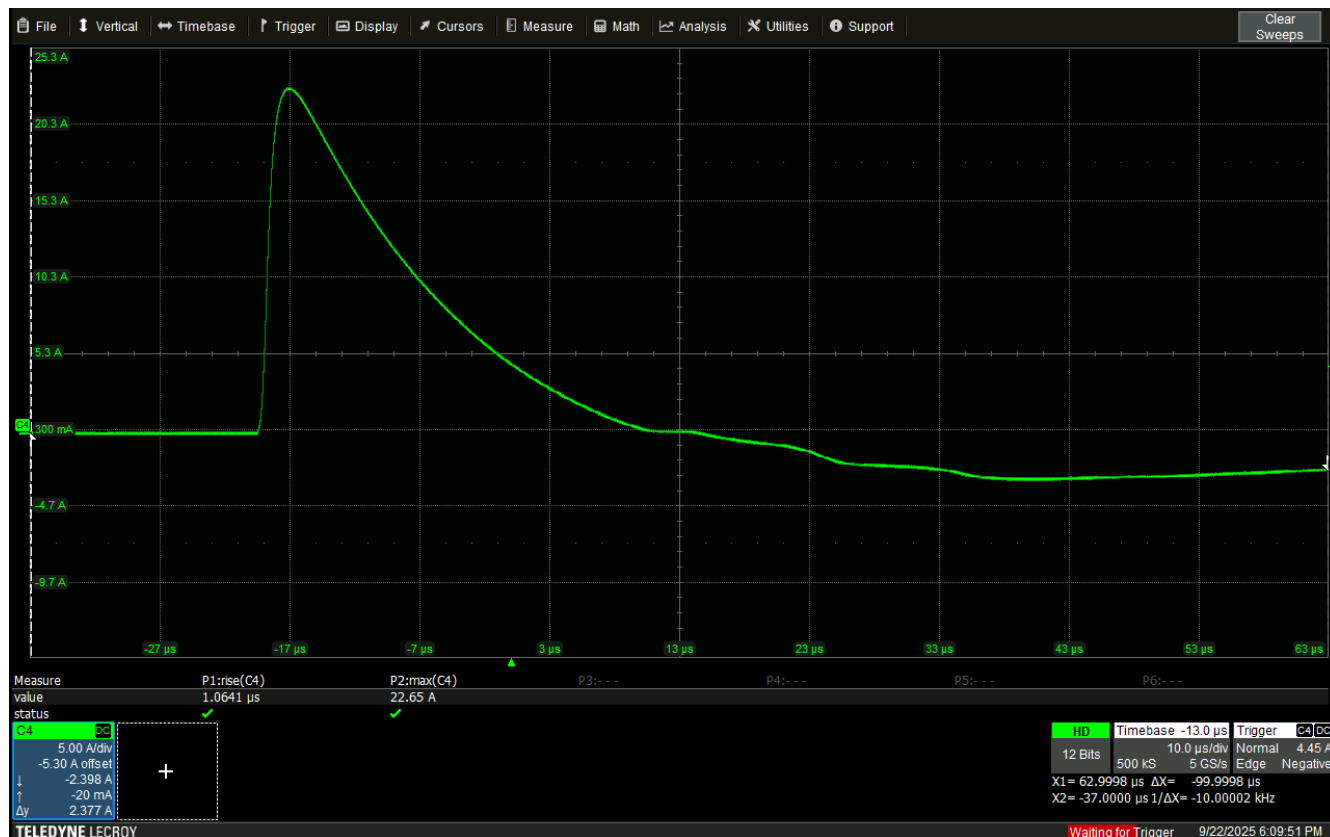
図 4. 1000V で補足したサージ波形
