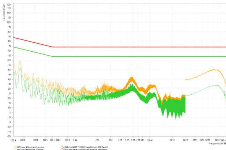
図 19. 伝導エミッション — PWM でアクティブ、VM = 12V、INx = 3.3V (20kHz、48Ω 負荷)
