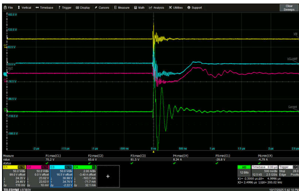
図 14. OUT ライン上の EFT (2.5kV) — 拡大図
