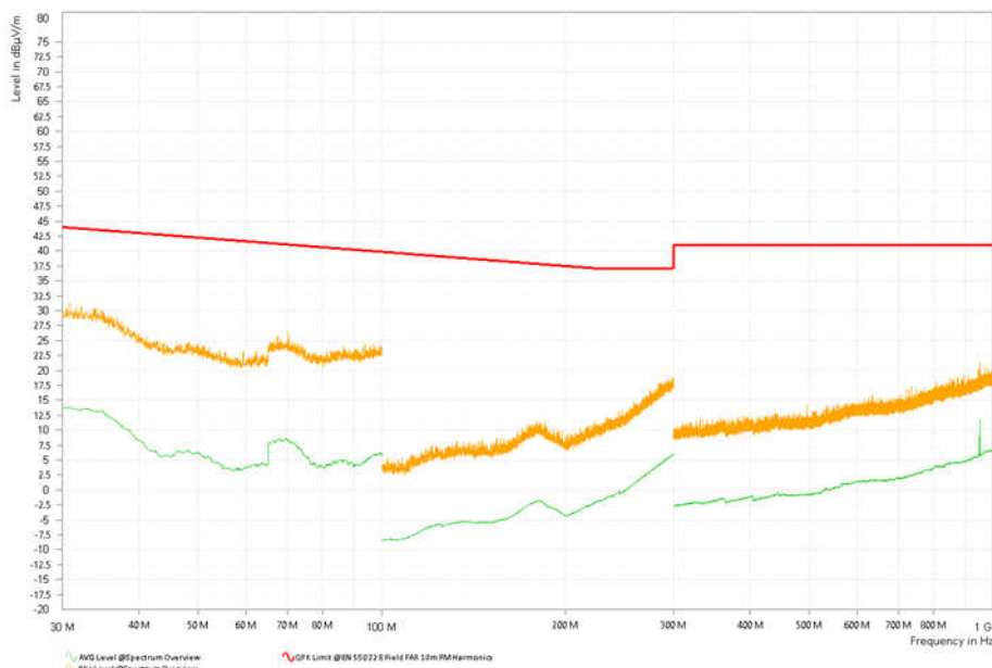
図 21. 放射エミッション — アンビエント (DUT スイッチングなし)
