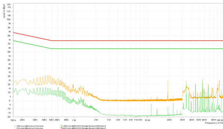
図 18. 伝導エミッション — アクティブ、VM = 12V、INx = 5V、48Ω 負荷
