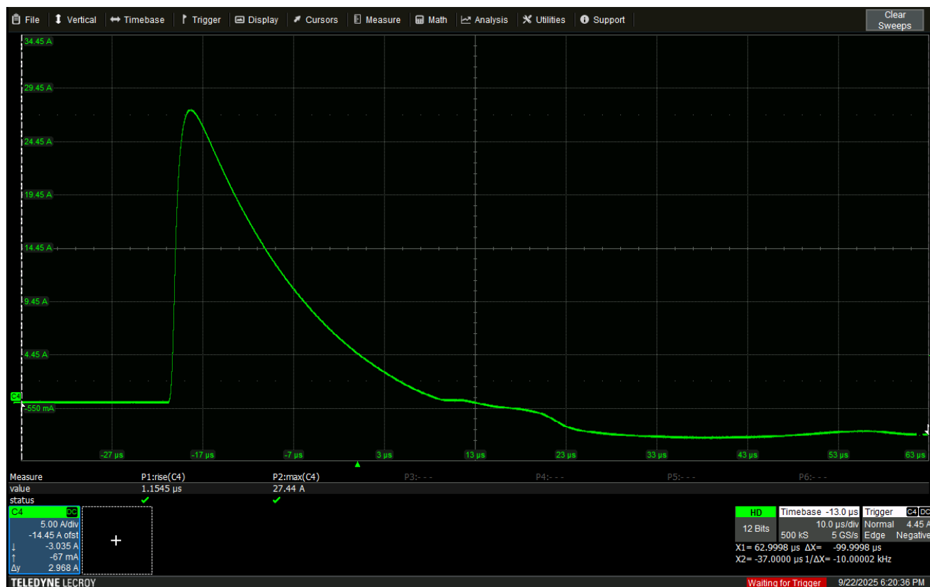
図 5. 1200V で補足したサージ波形
