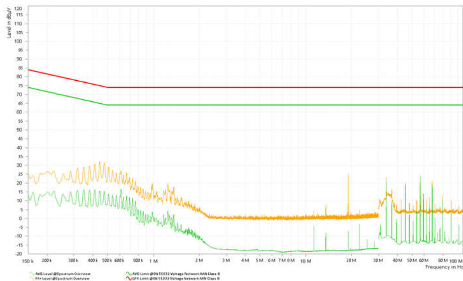
図 17. 伝導エミッション — スタンバイ、VM = 12V、INx = 5V、負荷なし
