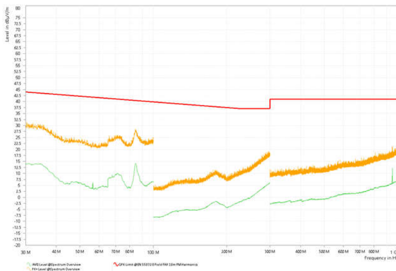
図 22. 放射エミッション — スタンバイ、VM = 12V、INx = 5V、負荷なし
