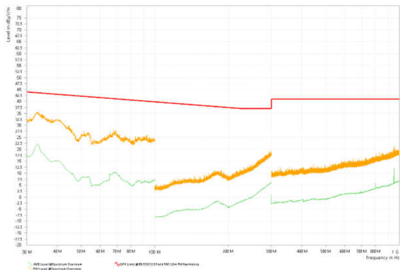
図 24. 放射エミッション — PWM でアクティブ、VM = 12V、INx = 3.3V (20kHz、48Ω 負荷)
