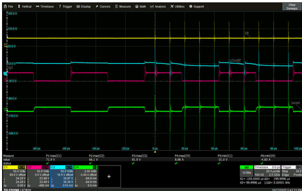
図 13. OUT ライン上の EFT (2.5kV)
