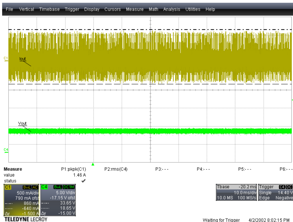
図 5-2. 強い COMP ピン補償による結果 (Vin = 12V、2 個つの LED)
