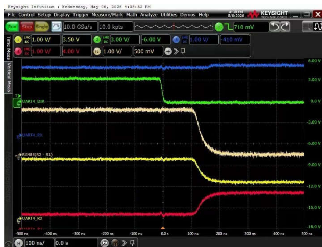
図 4-2. テスト結果: バスコンデンサ増加後はグリッチなし
