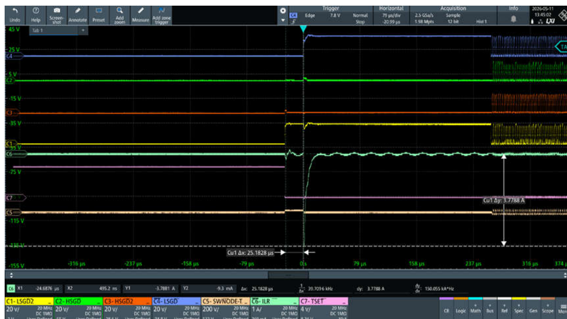
図 4-3. 起動時の補助ロジック – HO2 と LO2 を 200 \mu s パルスの間オン、C1 = LO2 ゲートドライブ、C2 = HO1 ゲートドライブ、C3 = HO2 ゲートドライブ、C4 = LO1 ゲートドライブ、C5 = タンク電圧、C6 = タンク電流、C7 = TSET ピン電圧
