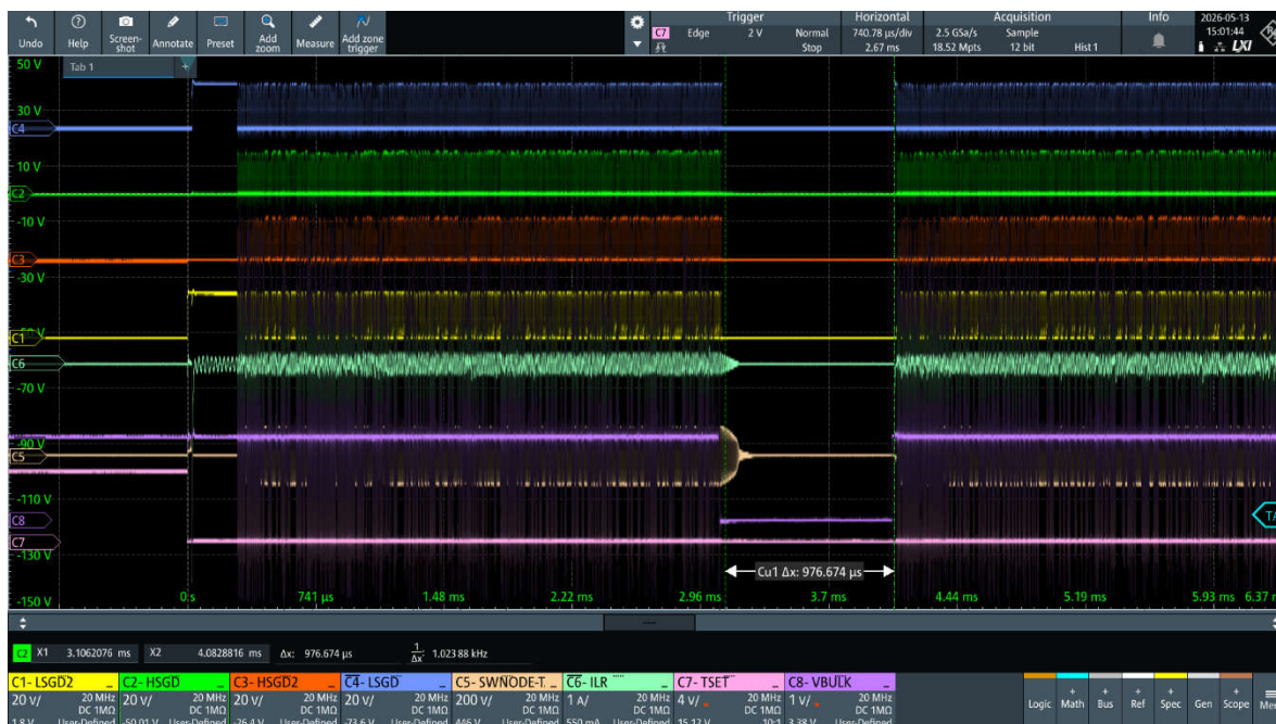
図 4-6. V_{in} = 100V 、無負荷時に模擬された BLK ブラウンアウトにおける補助ロジック動作、C1 = LO2 ゲートドライブ、C2 = HO1 ゲートドライブ、C3 = HO2 ゲートドライブ、C4 = LO1 ゲートドライブ、C5 = タンク電圧、C6 = タンク電流、C7 = TSET ピン電圧、C8 = バルクピン電圧
