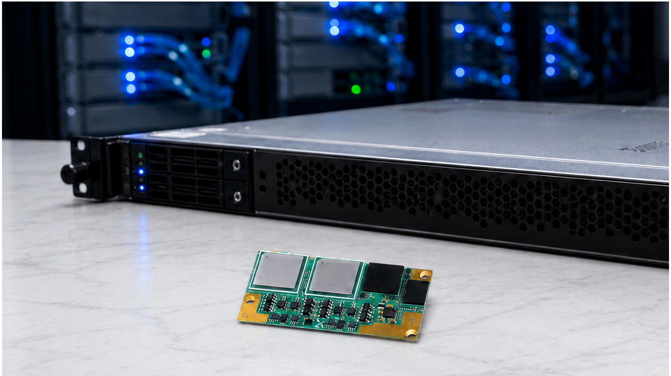
図 3. プロセッサ内部の 8 つの電圧をナノ秒単位の分解能で測定する、TI の 8 チャンネル SOM
