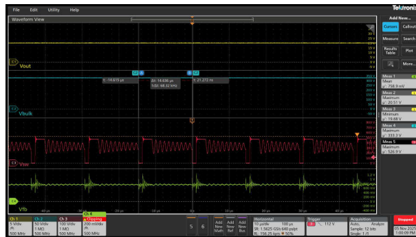
図 3-36. 230Vac/12W (68kHz 周波数/ Vfb - 0.76V)
