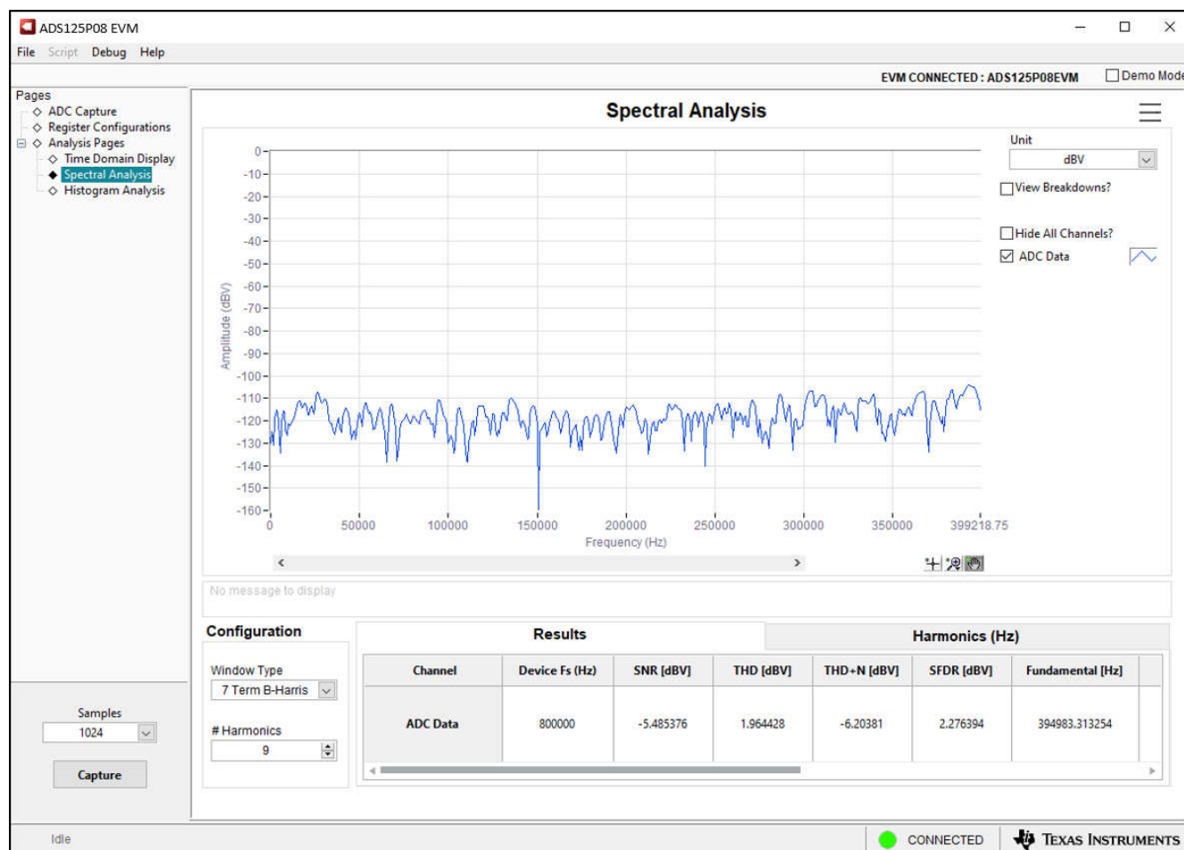
図 4-10. ADS125P08 EVM GUI 周波数ドメイン表示ページ
