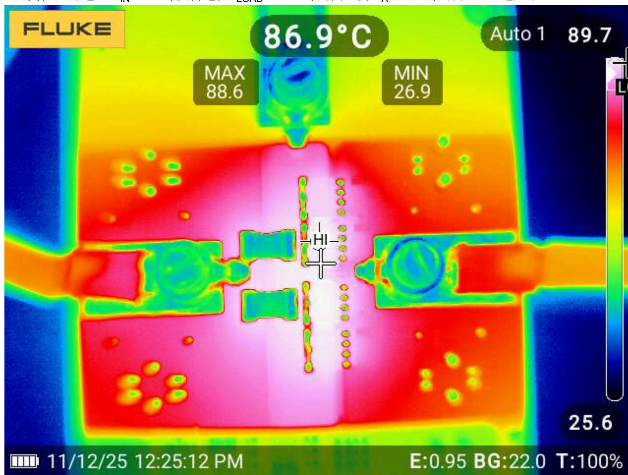
図 3-32. LM5066H1EVM の熱性能
