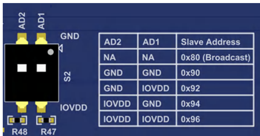
図 2-7. I 2 C アドレス選択のための DIP スイッチ S2-S3
