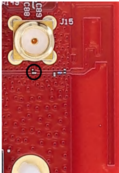
図 2-24. 放射試験または伝導試験用コンデンサ
