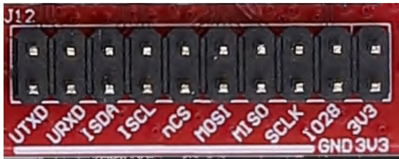
図 2-6. ワイヤレス マイコン インターフェイス用 J12 ヘッダー
