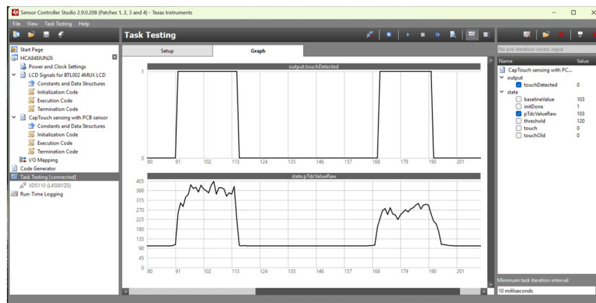
図 7-1. SCS でのタスク テスト: タッチ イベントは、2 つの上部グラフのピークです
