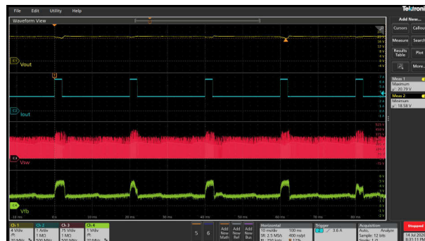
図 3-61. VIN = 90Vac (2x 定格電流が 2ms 間、0.9x 定格電流が 18ms 間)
