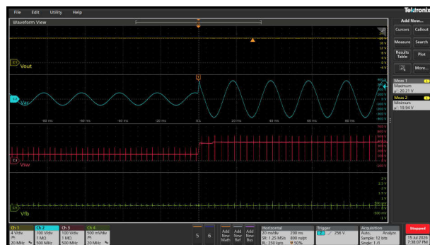
図 3-58. 20V / 無負荷時の 90Vac から 264Vac へのライン過渡応答
