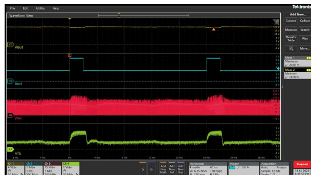
図 3-62. VIN = 90Vac (2x 定格電流が 2ms 間、0.9x 定格電流が 18ms 間)
