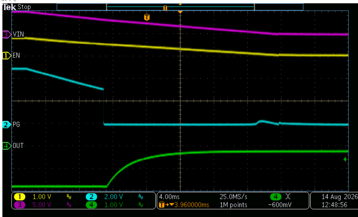
図 3-8. パワーグッド デアサート — 抵抗デバイダ経由で EN を立ち下がり VIN に接続
