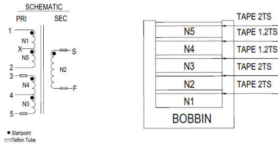
図 4-5. ATQ28-T-351K-W5:回路図
