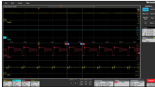
図 3-38. 230Vac/40W (91kHz 第 6 バレー スイッチング / Vfb - 1.71V)
