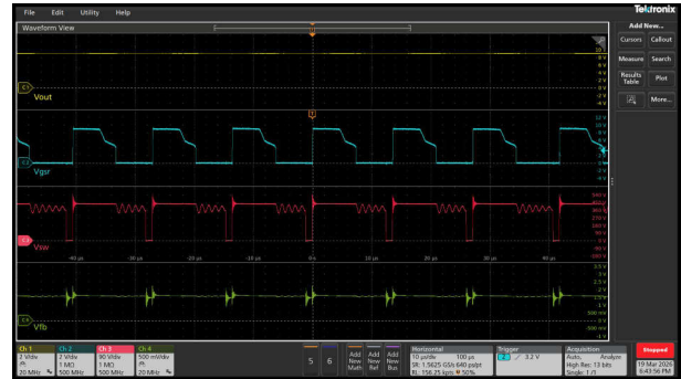
図 3-29. V_{in} = 264\text{Vac} 、 V_{out} = 9\text{V}
