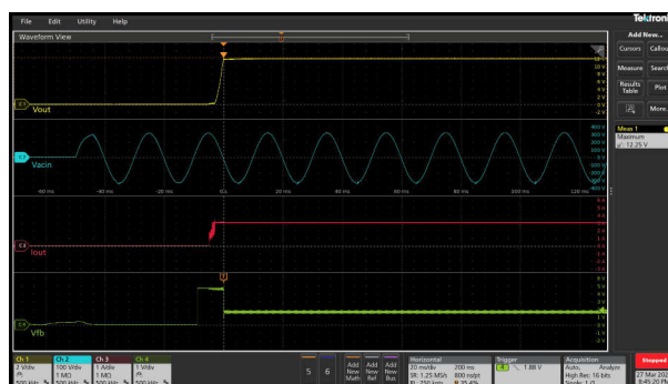
図 3-67. 12V および 3A (オーバーシュート = 250mV) での起動応答
