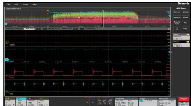
図 3-63. VIN = 90Vac (2x 定格電流が 2ms 間、0.9x 定格電流が 18ms 間) - ズーム
