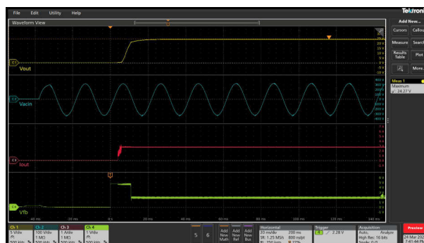
図 3-65. 24V および 2.71A (オーバーシュート = 270mV) での起動応答
