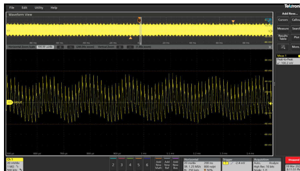
図 3-49. 全負荷時の V_{OUT} = 9V の標準リップル電圧 (100mVpp)
