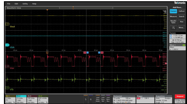
図 3-39. 230Vac/65W (115kHz 第 3 バレー スイッチング / Vfb - 1.93V)
