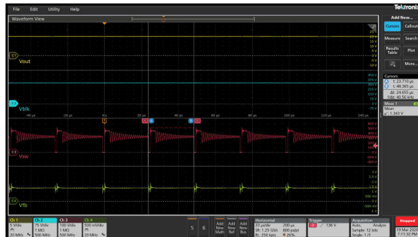
図 3-36. 230Vac/10W (40kHz 周波数 - フォールドバック / Vfb - 1.34V)
