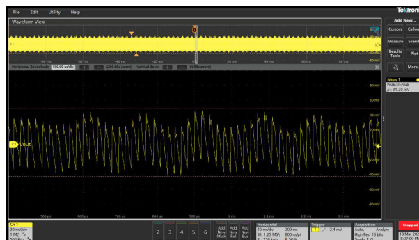
図 3-51. 全負荷時の V_{OUT} = 5V の標準リップル電圧 (91mVpp)
