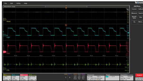
図 3-26. V_{in} = 90\text{Vac} 、 V_{out} = 9\text{V}
