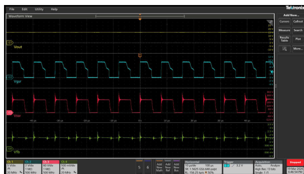
図 3-18. V_{in} = 90\text{Vac} 、 V_{out} = 15\text{V}
