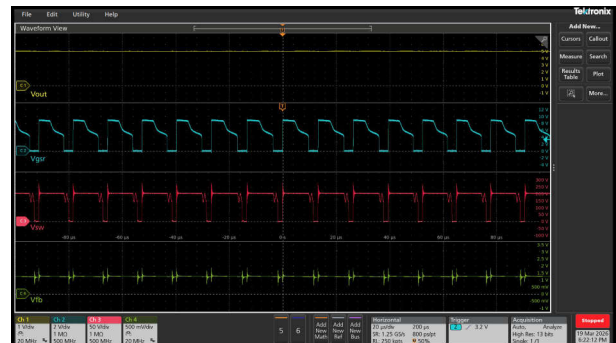
図 3-31. V_{in} = 115\text{Vac} 、 V_{out} = 5\text{V}
