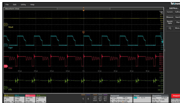
図 3-21. V_{in} = 264\text{Vac} 、 V_{out} = 15\text{V}
