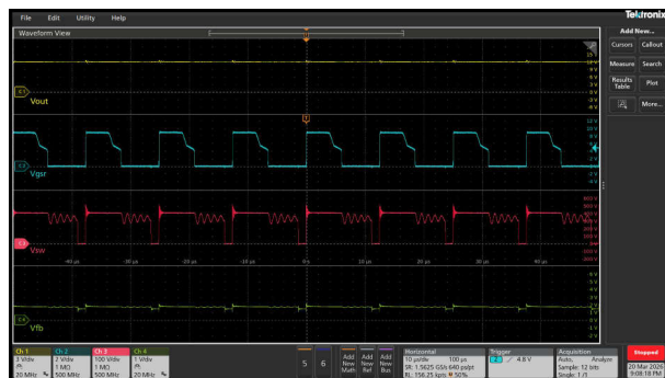
図 3-24. V_{in} = 230\text{Vac} 、 V_{out} = 12\text{V}
