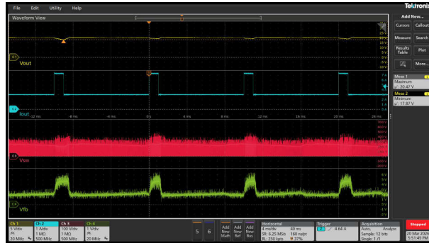
図 3-60. VIN = 90Vac (2.25x 定格電流が 1ms 間、0.9x 定格電流が 9ms 間)
