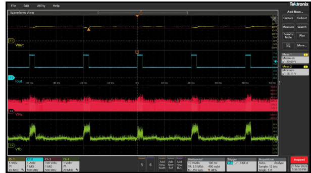
図 3-61. VIN = 90Vac (2x 定格電流が 2ms 間、0.9x 定格電流が 18ms 間)
