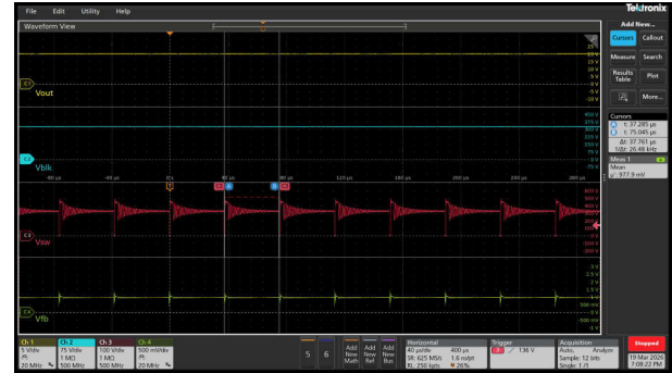
図 3-35. 230Vac/ 3W (25kHz 周波数 - フォールドバック / Vfb - 0.98V)
