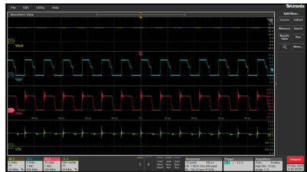
図 3-15. V_{in} = 115\text{Vac} 、 V_{out} = 20\text{V}
