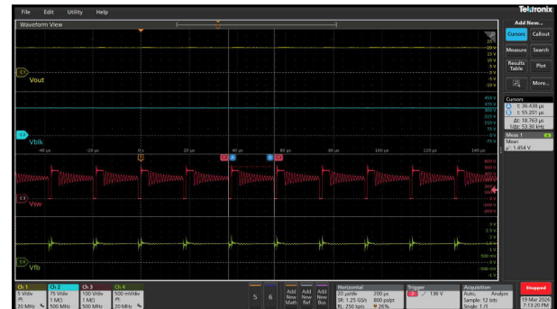
図 3-37. 230Vac/16W (53kHz 周波数 - フォールドバック / Vfb - 1.45V)
