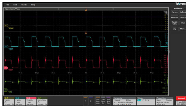
図 3-14. V_{in} = 90\text{Vac} 、 V_{out} = 20\text{V}
