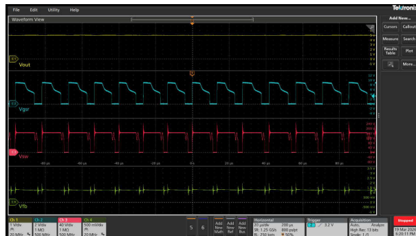
図 3-30. V_{in} = 90\text{Vac} 、 V_{out} = 5\text{V}
