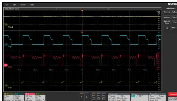
図 3-25. V_{in} = 264\text{Vac} 、 V_{out} = 12\text{V}
