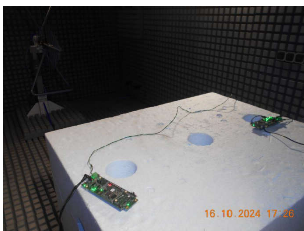
図 6-21. テスト設定 TIDA-010261 シールドなしシングルツイストペア放射エミッション
