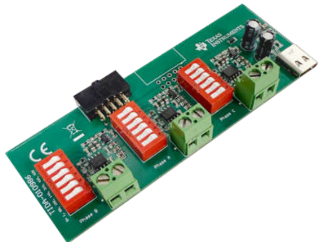
図 4. TIDA-010986 E メーター向け Rogowski 信号コンディショニング回路
