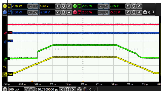
図 5-13. V_{CC1} 電源投入時のグリッチフリー - CAN バスはリセッチップを保持
