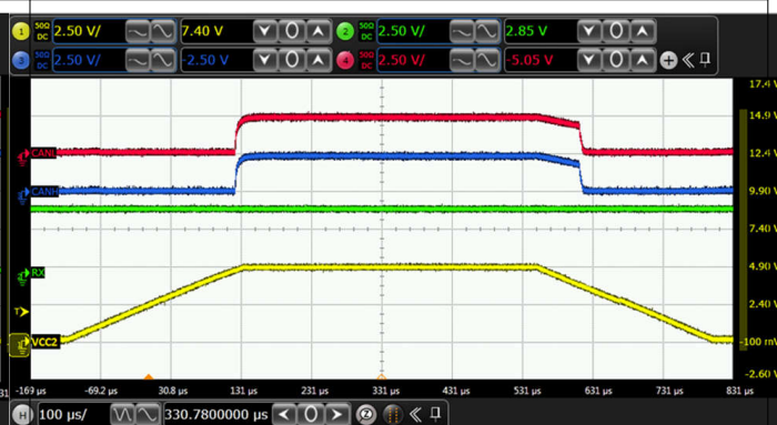
図 5-12. 1Mbps における TXD、RXD、CANH および CANL の標準波形
