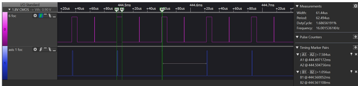
図 4-18. 6 軸 FOC ループの処理時間
