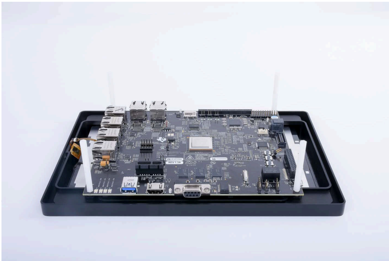
図 2-4. AM572x IDK EVM (LCD ディスプレイ アセンブリ付き) - 底面図
