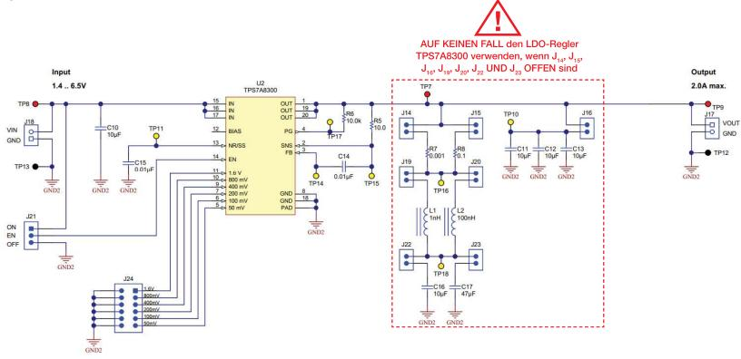
Abbildung 3: Schaltplan des LDO-Reglers TI-PMLK TPS7A8300
