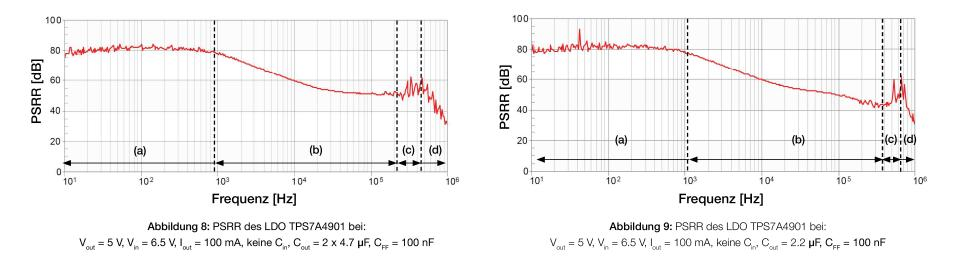
Die Kurven in den Abbildungen 8 und 9 zeigen den Einfluss der Ausgangskapazität auf das PSRR des LDO-Reglers TPS7A4901 bei geschlossenem Regelkreis. In Abbildung 8 sind eine niedrigere Durchtrittsfrequenz (Obergrenze von Bereich (b)) sowie ein größeres PSRR-Wert bei den hohen Frequenzen von Bereich (b) und in Bereich (c) als in Abbildung 9 zu beobachten. Dies sind die Auswirkungen der höheren Kapazität.
