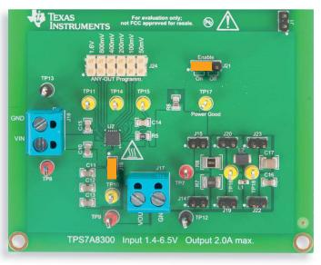
Abbildung 7: TPS7A8300-LDO-Platine: Jumperkonfiguration für Prüfung 2
