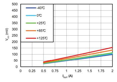
Abbildung 8: Dropout-Spannung vs. Ausgangsstrom des LDO-Reglers TPS7A8300 bei:  $V_{out}$  = 0.8 V und  $V_{in}$  = 1.4 V
