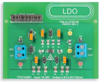
Abbildung 6: TPS7A4901-LDO-Platine: Jumperkonfiguration für Prüfung 1
