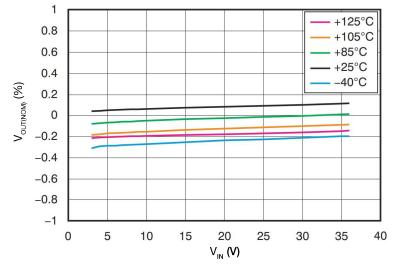
Abbildung 10: Temperaturabhängige Eingangsspannungsausregelung des TPS7A4901
