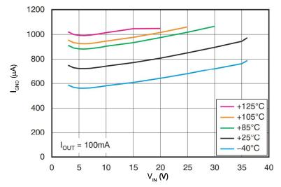
Abbildung 8: Massestrom des LDO-Reglers TPS7A4901 vs. Eingangsspannung bei 100 mA
