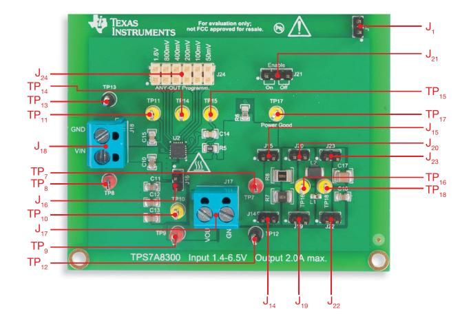
Abbildung 4: Ansicht der TI-PMLK TPS7A8300-LDO-Reglerplatine
