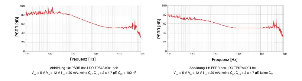
Die Kurven in den Abbildungen 10 und 11 zeigen den Einfluss der Phasenvoreilungskapazität auf das PSRR des LDO-Reglers TPS7A4901 bei geschlossenem Regelkreis. In Abbildung 10 ist das PSRR im mittleren bis hohen Frequenzbereich, in dem die durch die Phasenvoreilungskapazität eingebrachte Nullstelle einen starken Einfluss auf die Erhöhung der Durchtrittsfrequenz hat und dadurch zu einer Verbesserung des PSRR führt, größer als in Abbildung 11.
