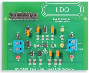
Abbildung 6: TPS7A4901-LDO-Platine: Jumperkonfiguration für Prüfung 1
