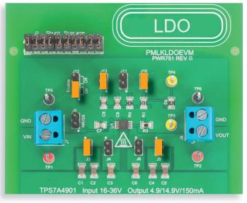
Abbildung 6: TPS7A4901-LDO-Platine: Jumperkonfiguration für Prüfung 1
