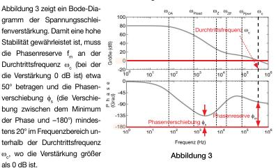
Die Verstärkungen  $G_{_{VC}}$  und  $G_{_{EA}}$  hängen von den internen Komponenten des LDO-Chips (Pass-Baustein, Gate-Treiber, Operationsverstärker, Rückkopplungszweig des Fehlerverstärkers  $R_{_{COMP}} - C_{_{COMP}}$ ), den externen RC-Bauteilen ( $R_{_{f1}}, R_{_{f2}}, C_{_{OUT}}, ESR$ ) und vom Laststrom  $I_{_{OUT}}$  ab. Die resultierende Schleifenverstärkung ergibt sich aus Formel (1):
