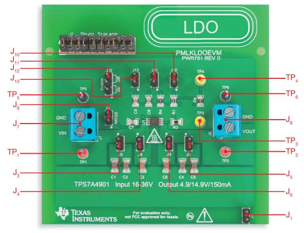
Abbildung 2: Ansicht der TI-PMLK TPS7A4901-LDO-Reglerplatine
