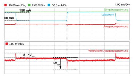
Abbildung 8: Einschwingverhalten des LDO TPS7A4901 unter Last bei: V<sub>out</sub> = 5 V, V<sub>in</sub> = 6 V, C<sub>out</sub> = 9.4  $\mu$ F, C<sub>FF</sub> = 100 nF und I<sub>OUT</sub> zwischen 50 und 150 mA schwingend
