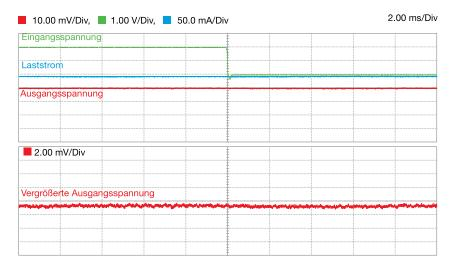
Abbildung 10: Einschwingverhalten des TPS7A4901 bei Eingangsspannungstransienten bei V<sub>out</sub> = 5 V, I<sub>OUT</sub> = 50 mA, C<sub>FF</sub> = 12 nF und V<sub>IN</sub> von 6 auf 8 V ansteigend
