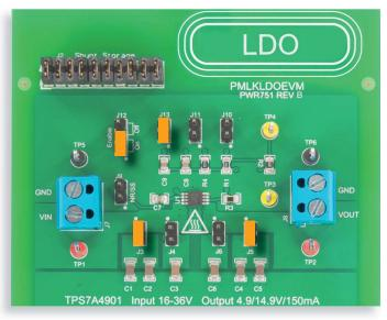
Abbildung 7: TPS7A4901-LDO-Platine: Jumperkonfiguration für Prüfung 2
