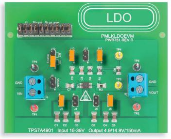
Abbildung 6: TPS7A4901-LDO-Platine: Jumperkonfiguration für Prüfung 1
