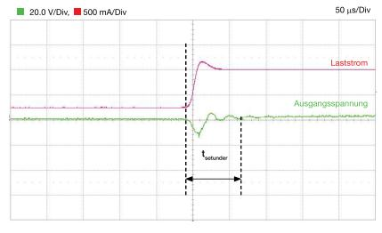
Abbildung 12: Einschwingverhalten des LDO-Reglers TPS7A8300 unter Last bei: V<sub>in</sub> = 2.5 V, V<sub>out</sub> = 1.5 V, I<sub>out</sub> = 0.25 A $\rightarrow$ 1.0 A, C<sub>out</sub> = C<sub>17</sub> = 47 µF, L<sub>out</sub> = L<sub>1</sub> = 1 nH, ESR<sub>out</sub> = R<sub>7</sub> = 1 mΩ
