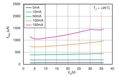
Abbildung 9: Massestrom des LDO-Reglers TPS7A4901 vs. Eingangsspannung bei 25 °C
