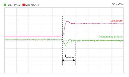
Abbildung 13: Einschwingverhalten des LDO-Reglers TPS7A8300 unter Last bei: V<sub>in</sub> = 1.8 V, V<sub>out</sub> = 1.5 V, I<sub>out</sub> = 0.2 A $\rightarrow$ 1.5 A, C<sub>out</sub> = C<sub>16</sub> = 10 µF, L<sub>out</sub> = L<sub>1</sub> = 1 nH, ESR<sub>out</sub> = R<sub>8</sub> = 100 mΩ
