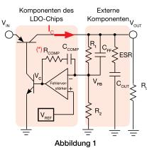
(\*) Der Widerstand  $\mathbf{R}_{\text{COMP}}$  wird typischerweise in LDO-Reglern mit keramischen Ausgangskondensatoren verwendet.
