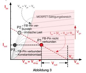
Im Sättigungsbereich wird der Drain-Source-Strom  $\rm I_{\rm ds}$  des MOS-FET mit Gleichung (3) berechnet:
