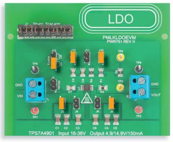
Abbildung 7: TPS7A4901-LDO-Platine: Jumperkonfiguration für Prüfung 2
