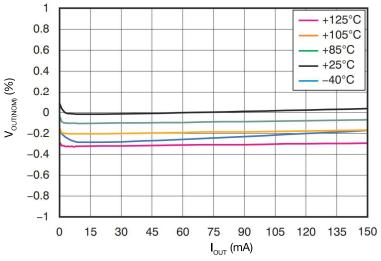
Abbildung 11: Temperaturabhängige Lastausregelung des TPS7A4901
