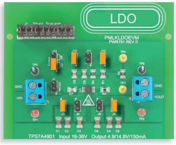
Abbildung 7: TPS7A4901-LDO-Platine: Jumperkonfiguration für Prüfung 2
