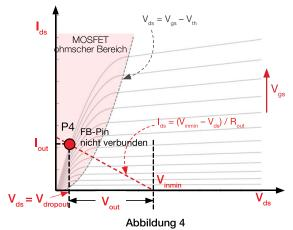
Im ohmschen Bereich wird der Drain-Source-Strom I<sub>ds</sub> des MOS-FET mit Gleichung (4) berechnet:
