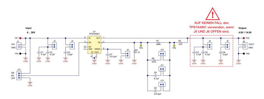
Abbildung 1: Schaltplan des LDO-Reglers TI-PMLK TPS7A4901
