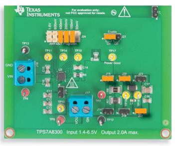
Abbildung 8: TPS7A8300-LDO-Platine: Jumperkonfiguration für Prüfung 1
