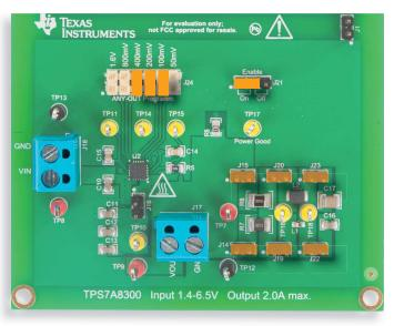
Abbildung 9: TPS7A8300-LDO-Platine: Jumperkonfiguration für Prüfung 2
