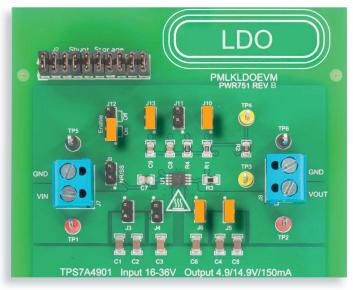
Abbildung 7: TPS7A4901-LDO-Platine: Jumperkonfiguration für Prüfung 2
