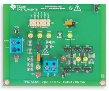
Abbildung 6: TPS7A8300-LDO-Platine: Jumperkonfiguration für Prüfung 1
