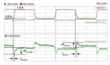
Abbildung 10: Einschwingverhalten des LDO-Reglers TPS7A8300 unter Last bei: V<sub>in</sub> = 1.8 V, V<sub>out</sub> = 1.5 V, I<sub>out</sub> = 0.2 A $\leftrightarrow$ 1.5 A, C<sub>out</sub> = C<sub>16</sub> = 10 µF, L<sub>out</sub> = L<sub>2</sub> = 100 nH, ESR<sub>out</sub> = R<sub>8</sub> = 100 mΩ
