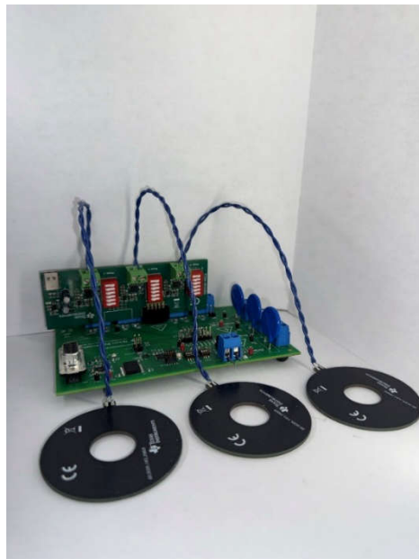
図 1-1. TIDA-010987、ADS131M08MET-EVM、TIDA-010986 を使用した 3 相 E メーター Rogowski コイルの設計
