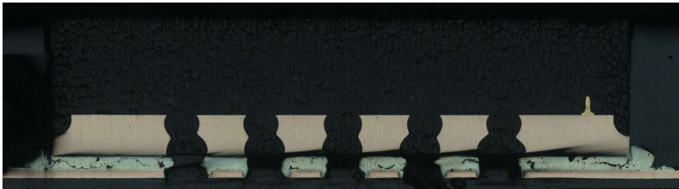
図 3-3. 10000 サイクル近い BLR 後にオーバーハングなしで半田付けされたリードの断面
