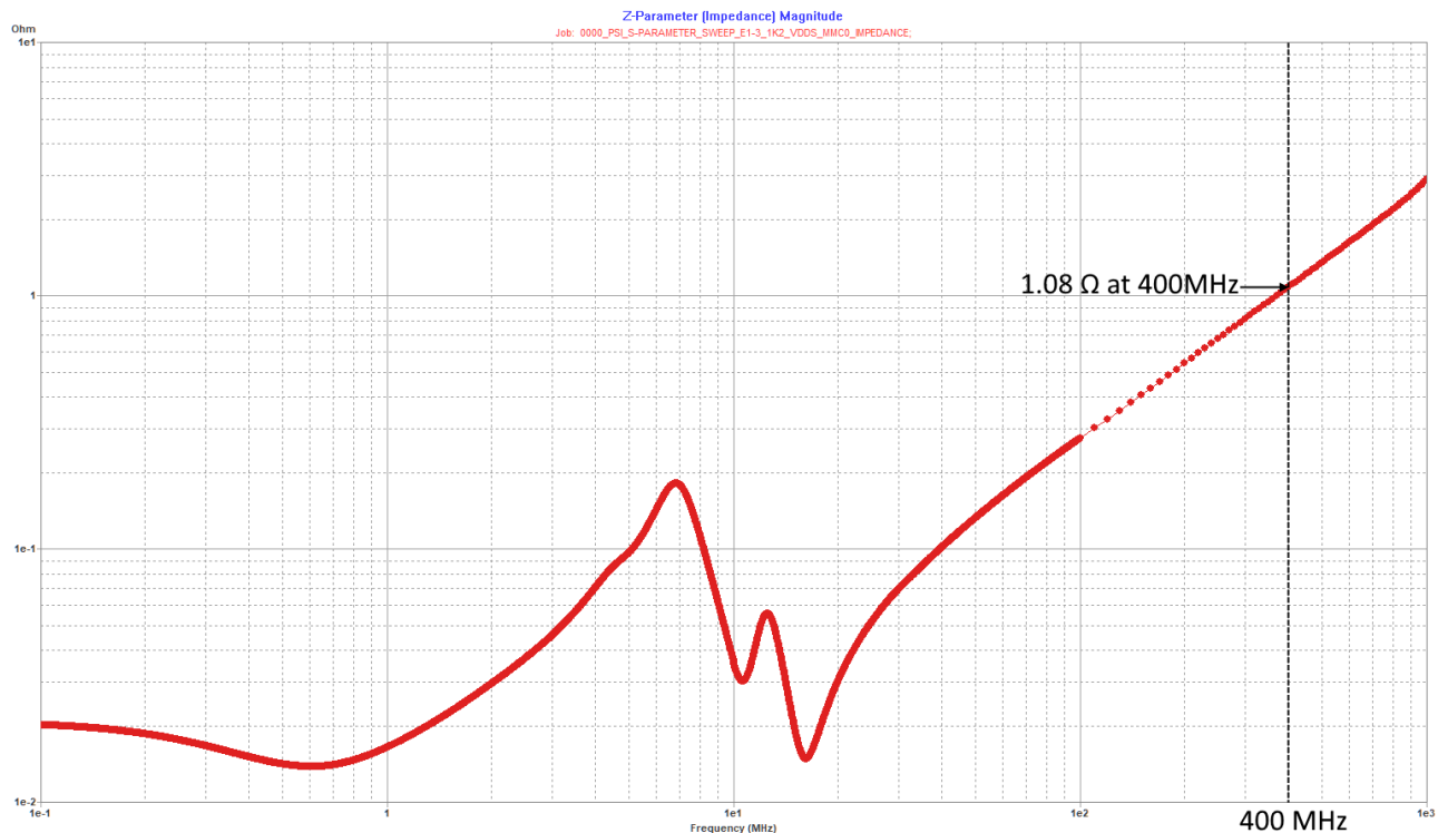
図 3-1. VDDS_MMC0 AC インピーダンス振幅と周波数との関係 (ボードのみ)
