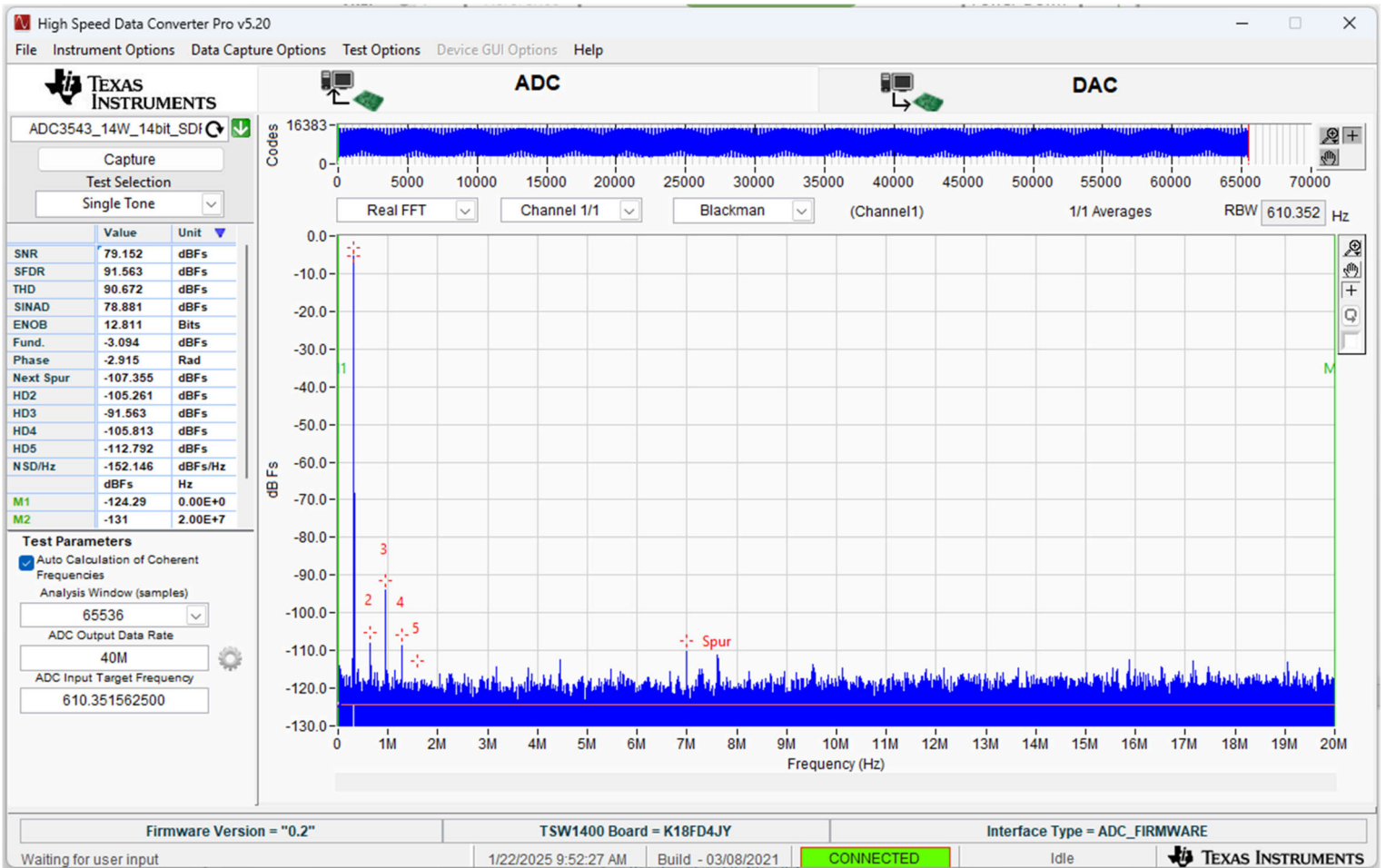
図 5-8. FFT 性能測定値:DC 付近、 F_{in} = 300\text{kHz}
